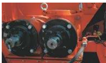
Система подачи щебня
