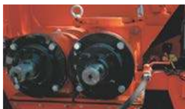
Система подачи щебня
