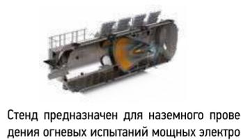
Стенд предназначен для наземного проведения огневых испытаний мощных электроракетных двигателей с водородом в качестве рабочего тела.
